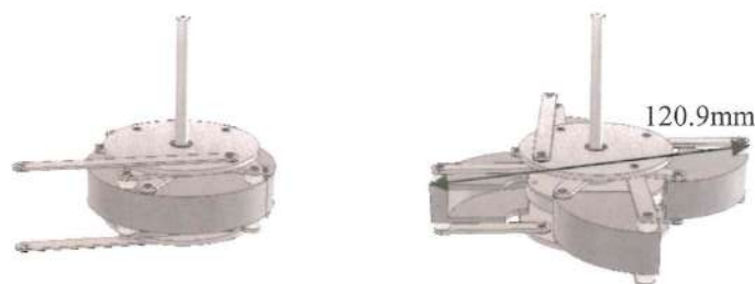
図 2 試作機の 3D-CAD 図面 (左：閉動作, 右：開動作)
