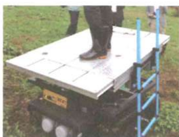
傾斜地に広い水平スペースを構築
