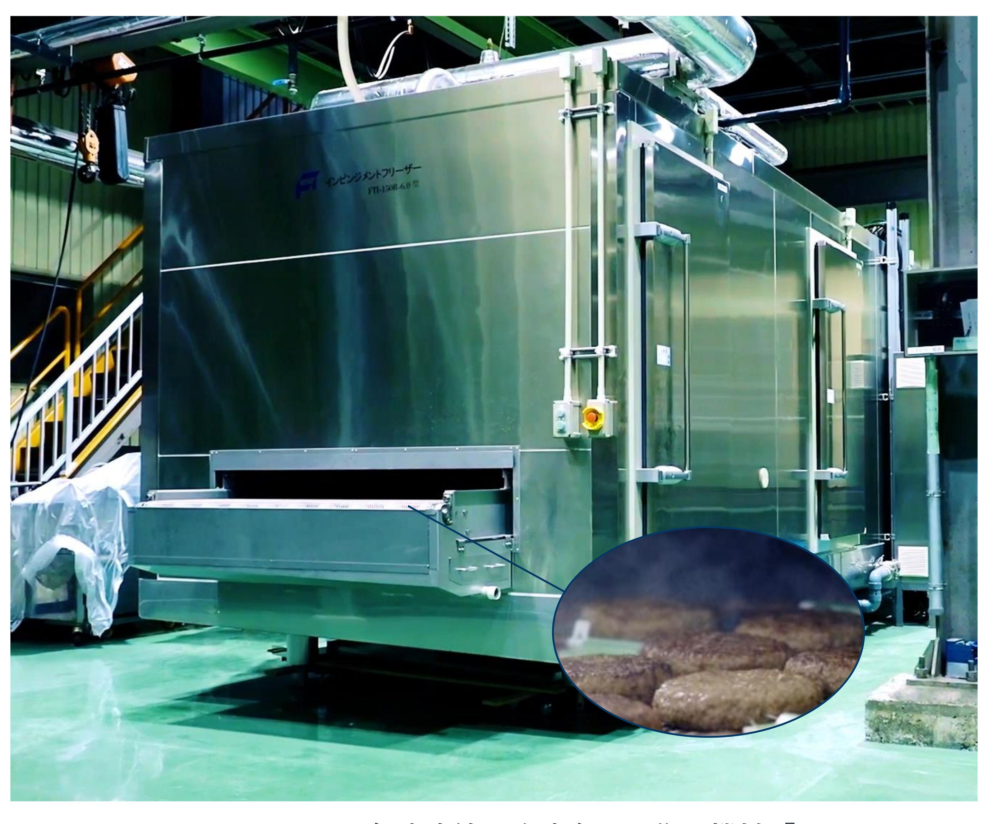
急速凍結で冷凍食品を作る機械「フリーザー」
