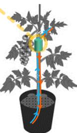
本実験により製作したセンサ(SHB法)を用いて, 植物(トマト)の樹液流量の測定に成功(下図)した。今後の課題は1)精度向上および2)植物への負担の評価である。
