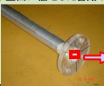
< 壁面に植毛した管路 >
