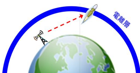
観測ロケットによる電離層中の電波伝搬特性観測
